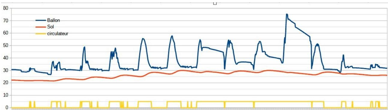
La conclusion est qu'il n'y a pas de risque de surchauffe du sol, peut-être un risque de surchauffe du ballon si on n'arrive pas à dissiper assez rapidement les calories dans le sol.
