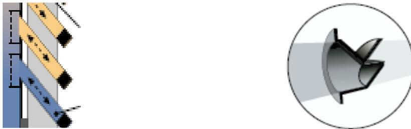
Figure 1.20 - Orientation des connexions pour empêcher le retour d'eau froide dans le ballon (à *gauche*) ou système anti-convection de Wagner & Co.
