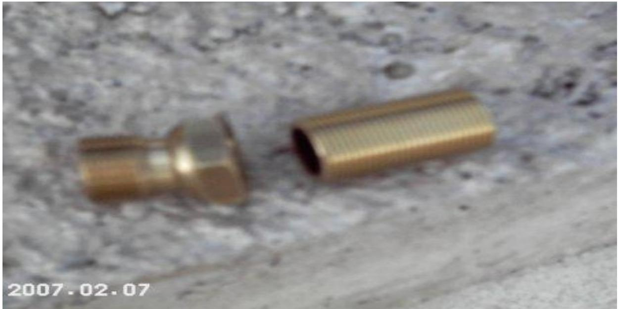
*Pièce de raccord de deux capteurs entre eux, démontable obligatoirement !*
