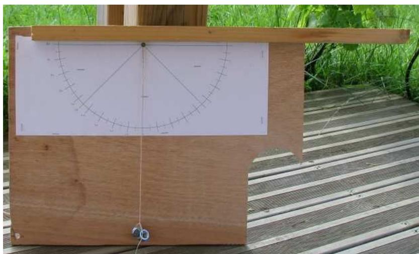
On se met à la place du panneau, on vise l'obstacle et on lit directement l'angle.
