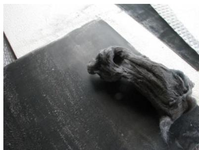
Après rinçage et séchage, un passage « léger » de laine métallique pourra contribuer à harmoniser la teinte et faire apparaître un aspect mat plus fonctionnel. Nous n'avons pas jugé bon de procéder au brunissage de la face arrière de l'absorbeur.
