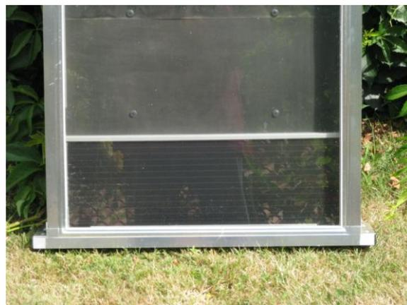
Une bande d'aluminium a été collée sur le joint et le bord du vitrage, pour améliorer encore l'étanchéité, et bien entendu avant la pose des 3 pare-closes, puisqu'il n'y en a pas en bas !
