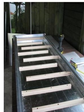
Il sera sans doute utile de pratiquer quelques entailles sur le bord des tasseaux, et éventuellement de déposer une pièce d'Alu autocollant, après avoir fixé ces chicanes avec de vis à bois TF de la bonne longueur .L'écartement sera fonction des dimensions des absorbeurs( ?), cœur de notre capteur aérothermique, et enfin détaillé dans la suite du texte.
