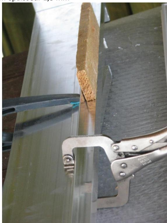
La cornière la plus réduite sera fixée à l'intérieur du cadre, en tenant compte de l'épaisseur du vitrage, plus quelques millimètres pour tenir compte du joint EPDM qui sera collé sur les deux faces du dit vitrage et assurer sa parfaite étanchéité ; une cale de bois calibrée servira à positionner correctement ces éléments avant de procéder à la pose des rivets.
