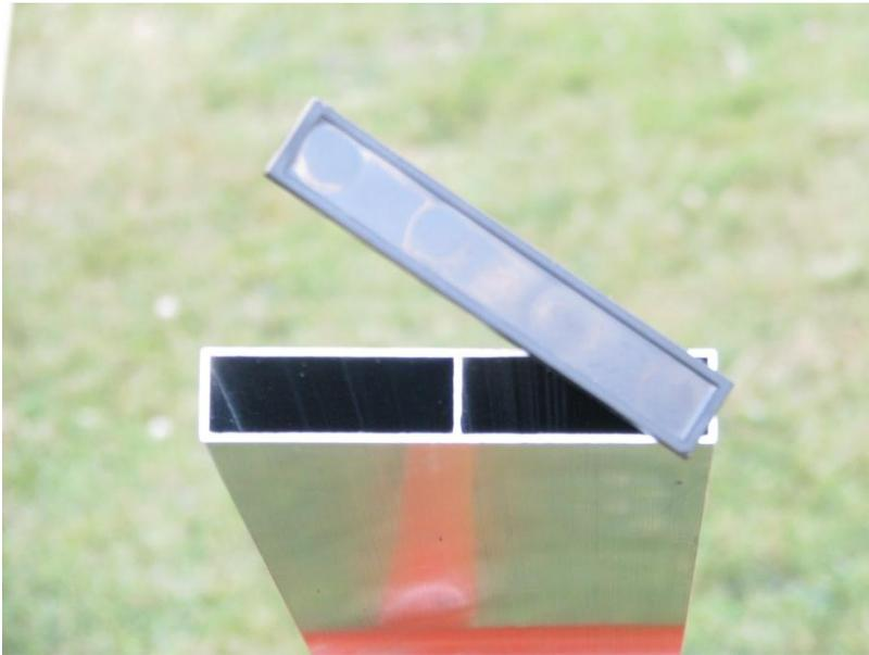
Leur hauteur de 100 mm suffira pour implanter tous les éléments de notre capteur : vitrage, absorbeur (?), chicanes, fond et isolation arrière.
