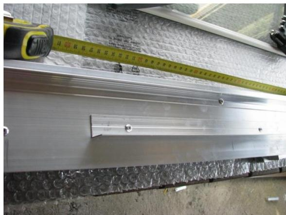
Il reste ensuite à fixer, toujours au moyen de plusieurs rivets, quelques tronçons de la grosse cornière pour pouvoir retenir à la fois le fond du capteur en contreplaqué CTBX de 10 mm d'épaisseur et l'isolant arrière rigide de 20 mm, genre Styrodur, peu sensible à l'humidité. Ce dernier sera collé directement sur le bois avec une colle adaptée, avec le recours de quelques vis le temps de la prise.
