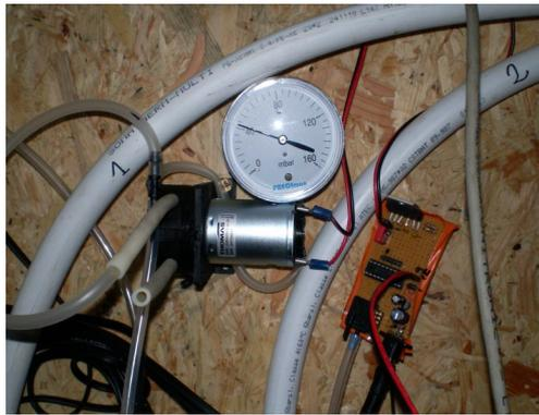
La pompe péristaltique et le manomètre qui indique la pression dans la poche, correspondant à la profondeur à laquelle se trouve le tube (120mbar = 1,2 m d'eau, au fond de la cuve – ici 40mbar, donc au 2/3 de la hauteur). Une petite carte électronique indépendante commande le moteur et communique avec la régulation principale sur le bus 1 Wire des capteurs de température.
