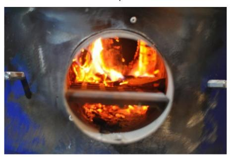
Une fois que le feu est bien activé, on bouche l'entrée d'air primaire à l'aide d'un bouchon qui dispose d'une petite trappe de réglage. En stage, tout est fait main !
