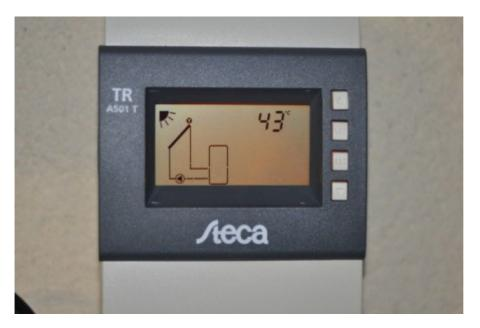
Dès que la température du rocket dépasse de 4 °C la température du cumulus solaire, la pompe de circulation se met en route tranquillement. La température du liquide caloporteur est de quelques degrés supérieurs à celle mesurée par la sonde située à l'intérieur du ballon, il est donc protégé des surchauffes et de sa dégradation anticipée.
