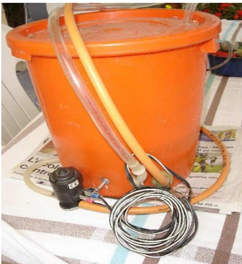
Pour le remplissage de l'installation, j'ai réalisé un système à partir d'un seau de monopropylène glycol sur lequel j'ai adapté une petite pompe 12 volts, style lave glace. Le refoulement de la pompe est équipé d'un tuyau de plastique que je branche sur l'entrée du groupe de transfert. La pompe étant branchée sur une batterie, le circuit complet (35 litres) est rempli à 2 bars en 30 minutes.
