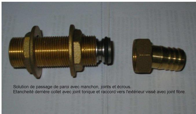
Solution de passage de paroi avec manchon, joints et écrous.
