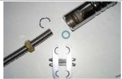
Couper proprement le tuyau (meuler au besoin) et insérer le tuyau dans l'écrou.
