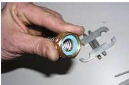
Rapprocher l'écrou et placer le joint.
