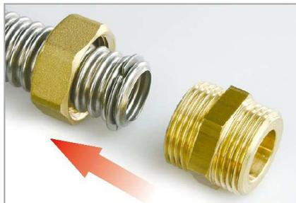
Enfiler l'écrou sur le tube. Poser le segment de renfort dans le premier ou le deuxième creux.
