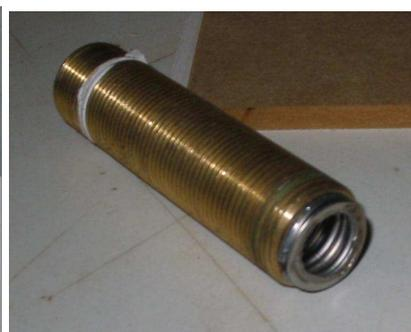
Collet battu manuellement au marteau et pièces pour serrage - Collet après serrage avec pièce et écrou
