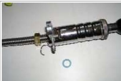
Placer le tuyau et la matrice dans le marteau.
