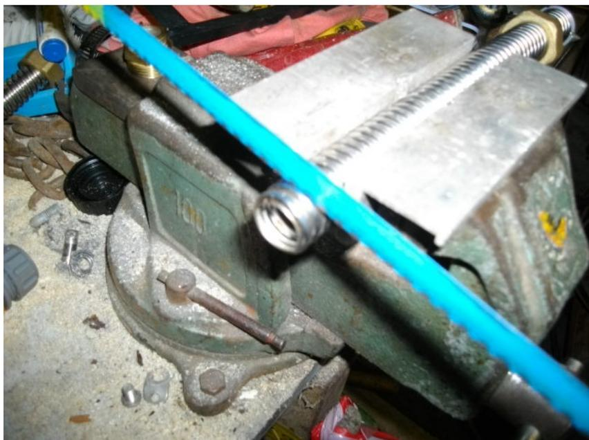
Je mate légèrement le tube avec un marteau pour pouvoir utiliser 2 spires sinon le raccord  $\frac{3}{4}$  ne mord pas dans l'écrou (je suis en diam 16 dans l'exemple).
