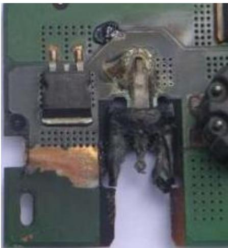
Ce risque provient du connecteur du câble au circuit imprimé dont la cosse présente une force de serrage insuffisante. Il en suit un mauvais contact qui présente une résistance telle que l'échauffement détruit la diode adjacente, délamine le circuit imprimé et peut provoquer un départ de feu surtout si le capteur est encastré à la toiture. Sur les photos des documents on voit bien que le point le plus chaud a été au niveau de la zone de contact de la cosse.
