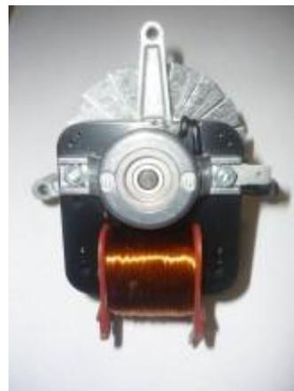
La vitesse de rotation de ce type de moteur asynchrone dépend principalement de la fréquence du courant dans la bobine. Etant donné le faible couple de ces moteurs, il est possible de diminuer la vitesse sur une faible plage en baissant la tension d'alimentation entre 10 et 20 %.
