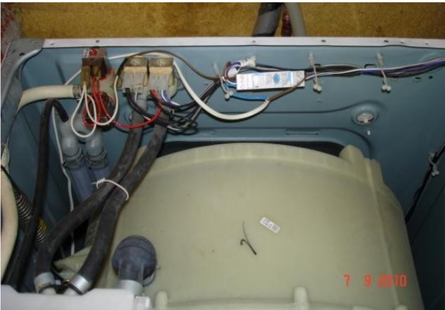
relais temporisé (Crouzet) à contact inverseur alimente l'électrovanne pour l'arrivée d'eau chaude sortant du mitigeur (prélavage-lavage) et l'autre pour froide (pour le rinçage).
