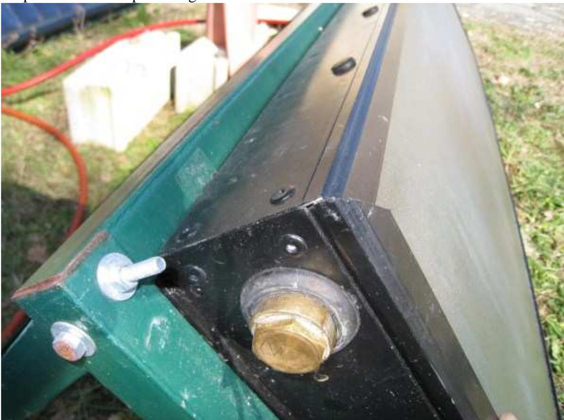
Après vérification de l'étanchéité, nettoyage de la vitre et de son joint puis remontage des baguettes. Il faut bien vérifier avant de les remettre qu'elles sont bien placées par rapport aux dimensions du panneau. C'est au pouillième de millimètre !
