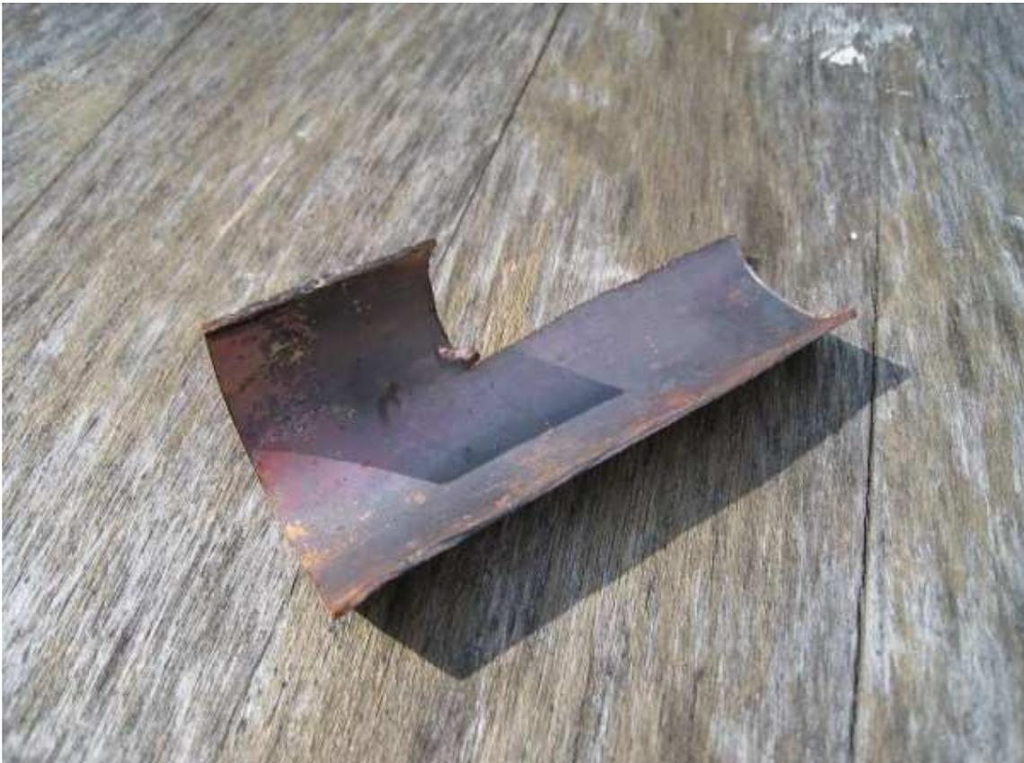
Le patch est tiré d'un morceau de cuivre en diamètre 16mm, écroui au chalumeau pour le rendre tendre et formé sur un tube de diamètre équivalent à celui où se trouve la fissure.
