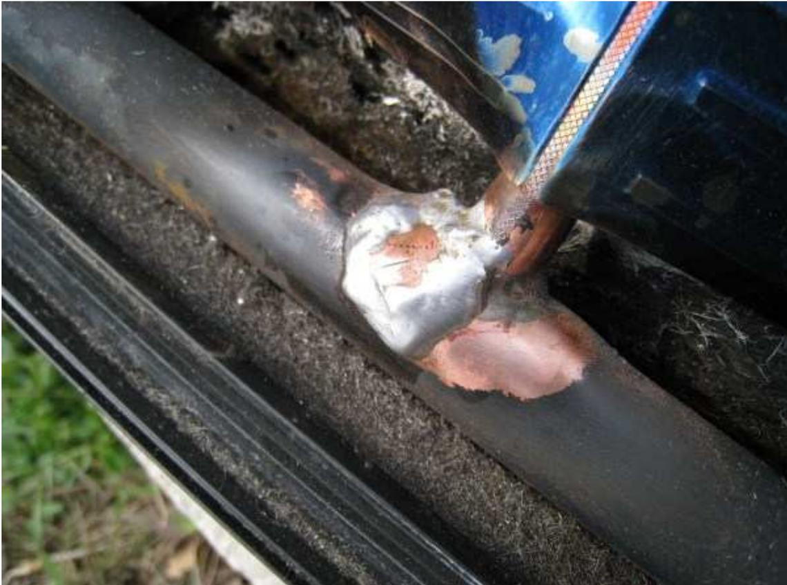
Puis soudure à l'étain au chalumeau « ordinaire ». Il faut que la température ne soit ni trop élevée (pour éviter que l'étain fondu ne coule du tuyau), ni trop basse (pour que l'étain pénètre bien par capillarité). Le mieux est d'y aller en 2 fois. La deuxième couche d'étain est limite pâteuse et fait l'épaisseur garantissant l'étanchéité.
