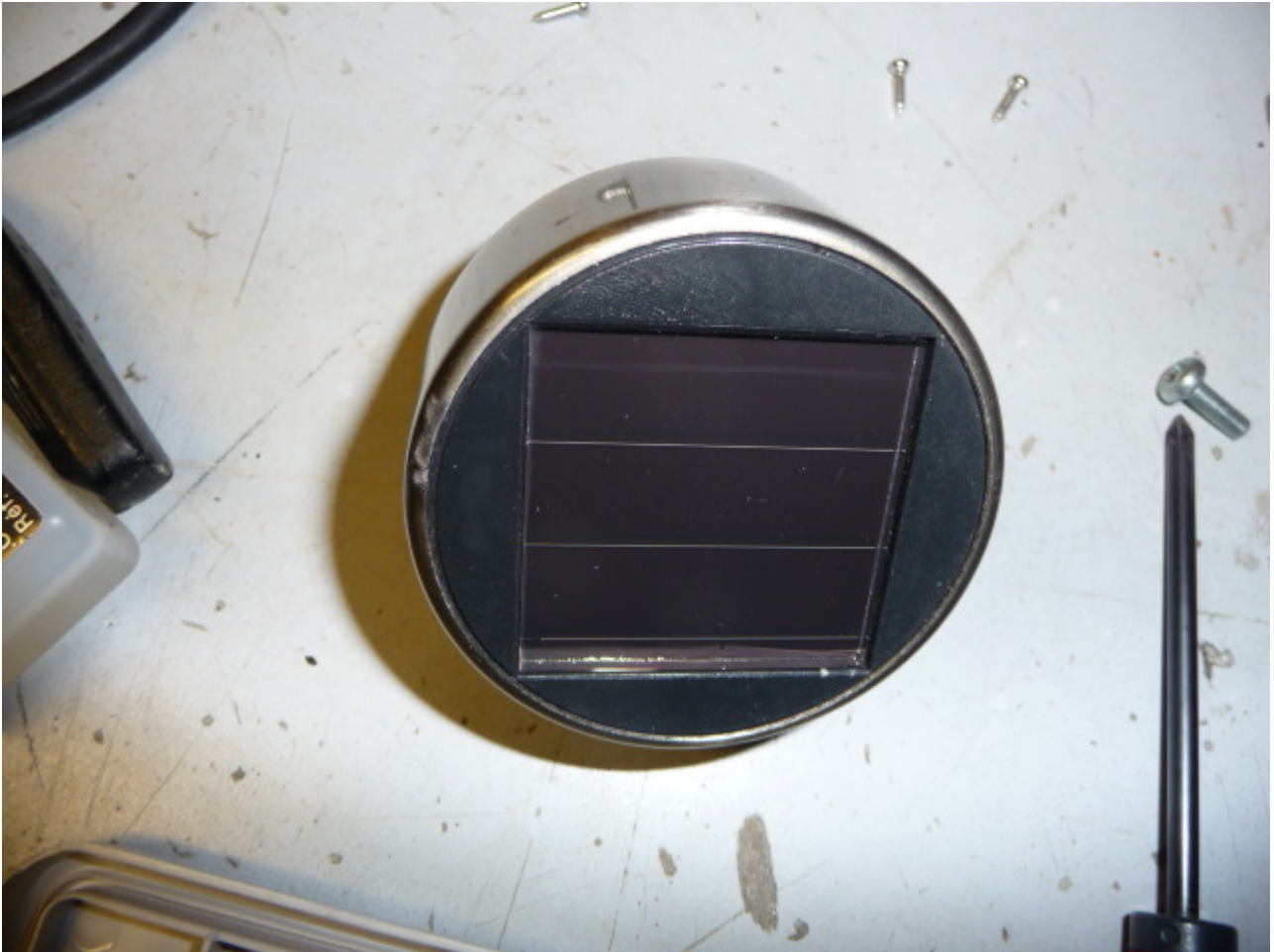
La cellule avant transformation, dans sont boîtier d'origine IP44 chinois.
